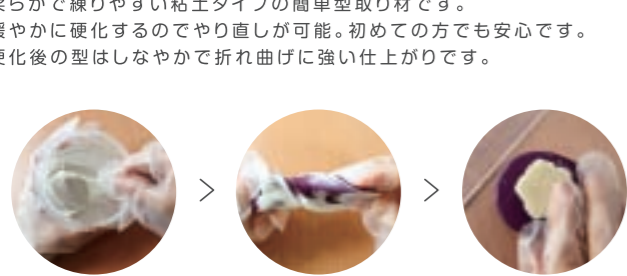
A材/B材を同量取る A材/B材を混ぜる 原型を埋め込む
